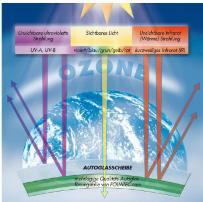
FOLIATEC® Qualitäts-Autoglas-Tönungsfolien haben die Eigenschaft, Sonneneinstrahlungen zu filtern oder abzuschirmen. Durch den hochwertigen, mehrlagigen Materialaufbau werden UV-, Licht- und Wärmestrahlung wirksam selektiert. Dabei unterscheiden sich die erreichten Rückweisungs- und Filterwerte je nach Folientyp und sind abhängig von dem spezifischen Materialaufbau.
