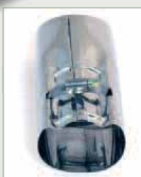
Universal Auspuffblende, oval, 160mm lang Durchmesser 65/55 mm Passend für Auspuffendrohre von 35 bis 50mm Durchmesser Art.-Nr. 291003 UVP 24,90
